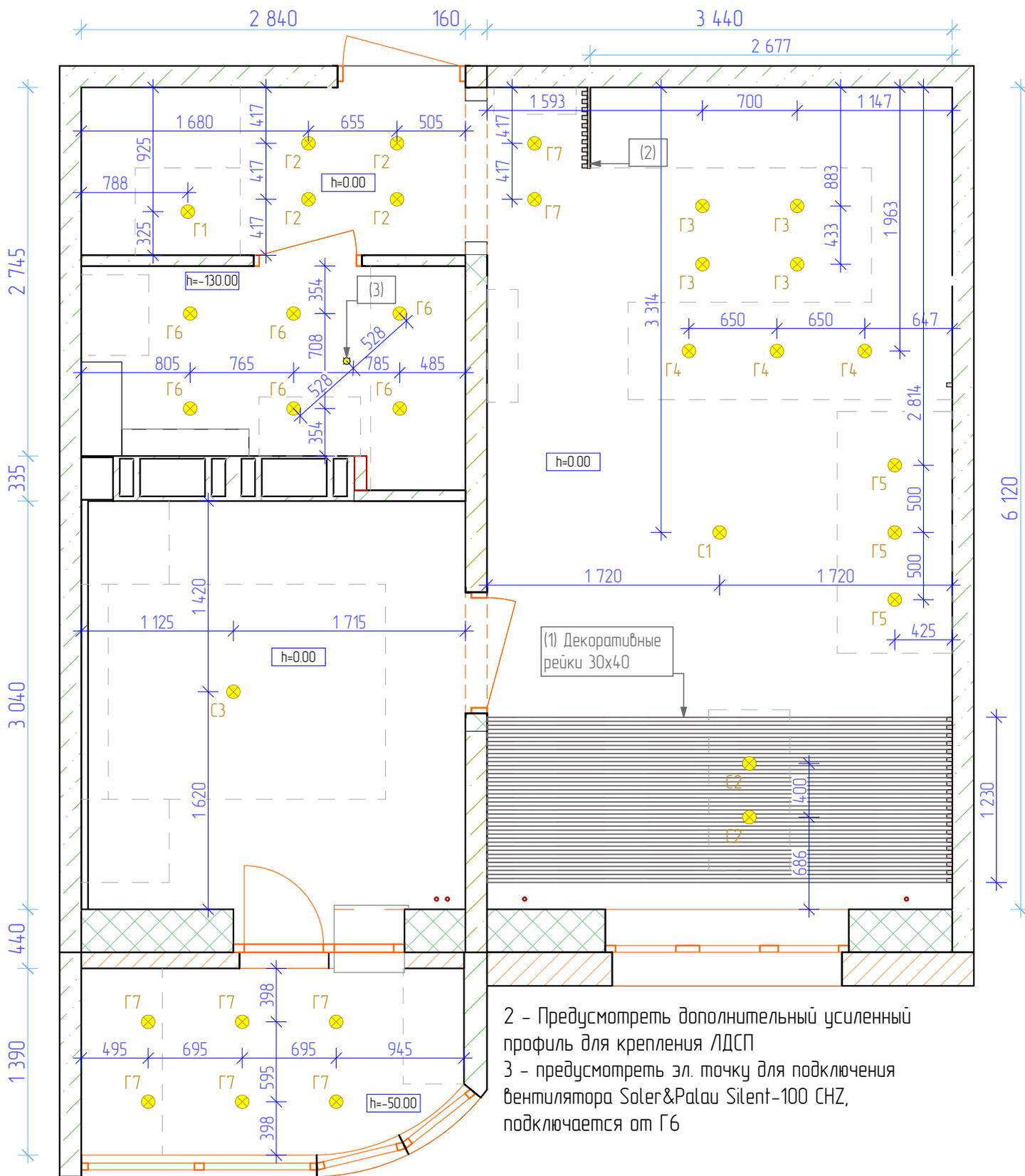
Потолки: Выравнивающий слой ГК. Опустить минимально от нижней отметки уровня существующего потолка,  $h = \pm 50,0$  мм
