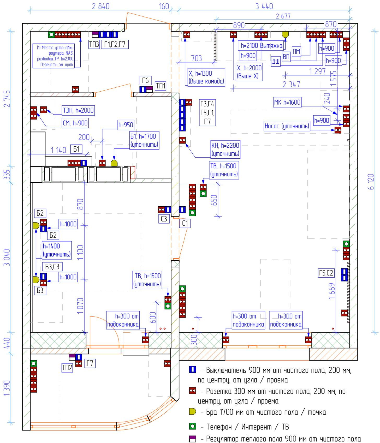
1 - Предусмотреть вывод оптического кабеля, эл. розеток для подключения модема, NAS, и проч. Предусмотреть розетки для коннектора 8P8C, для развязки витой пары (TP) по всей квартире. Перенести эл. щит.
